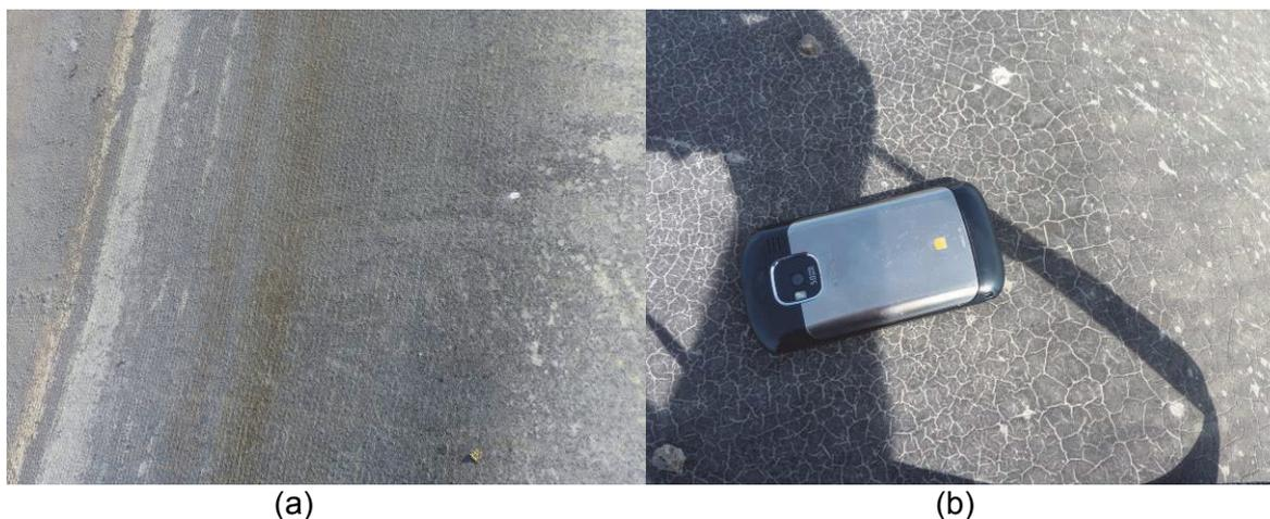
Figure 2. Vues de la surface de la géomembrane en bitume oxydé (a) et de la géomembrane en bitume élastomère (b)
