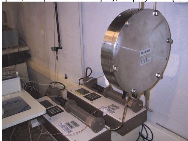
Figure 3. Appareillage de mesure selon la norme NF EN 14150
